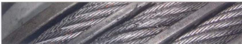
Cable con roturas de alambres distribuidas de forma aleatoria.
